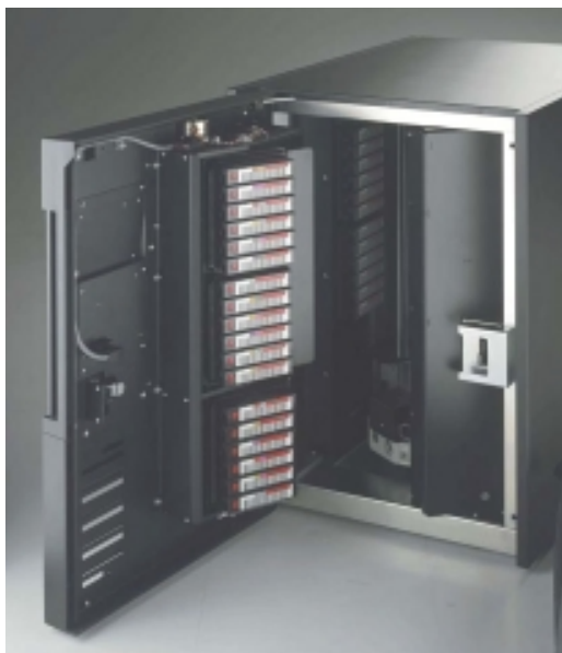
Un IBM Ultrium 3583 avec le capot ouvert...
